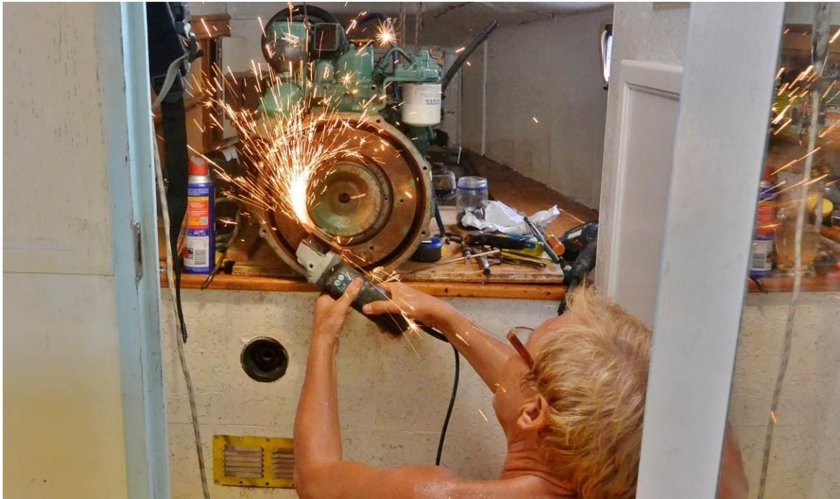
mich dann erholen. Es wird in etwa zwei Wochen dauern bis bestellte Teile aus Europa eintreffen werden. Die Dämpfer Scheibe ist ausgeschlagen, natürlich sind die haltenden Bolzen bombenfest- etwas gewaltsam müssen sie gelöst werden! Die Antriebsachse zum Getriebe hin ist schadhaft, im Kühlsystem lauern einige Fehler, zwei Lichtmaschinen sind kaputt... es gibt einiges zu ordern.
